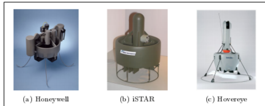
Figure 2.11 Exemples de drone à rotors coaxiaux à carène longue Tirée de A. Drouot (2013)
