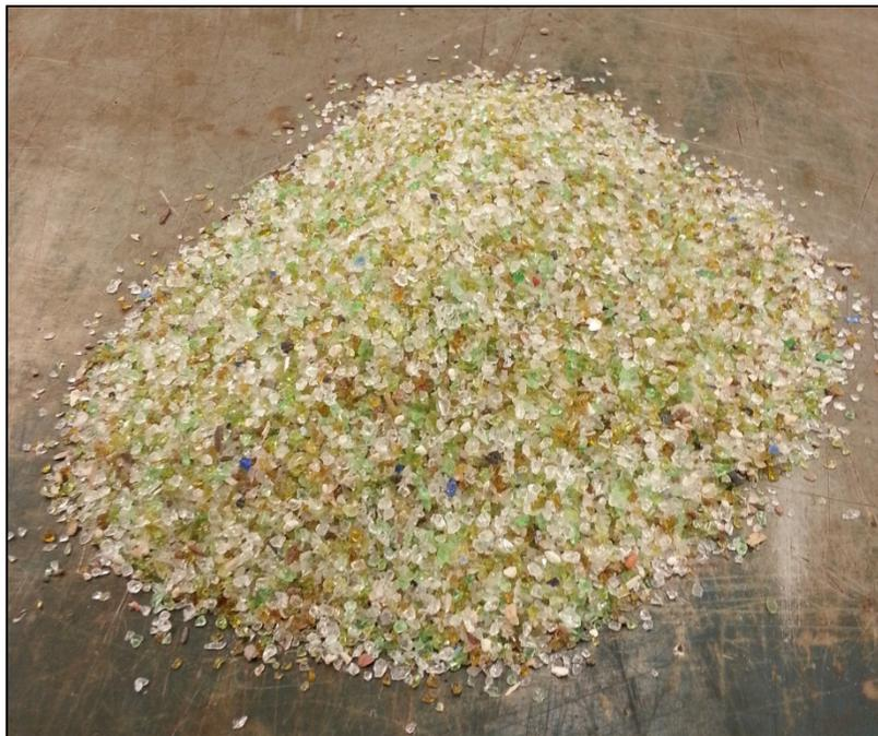
Figure 1.1 Exemple de verre de type mixte concassé
