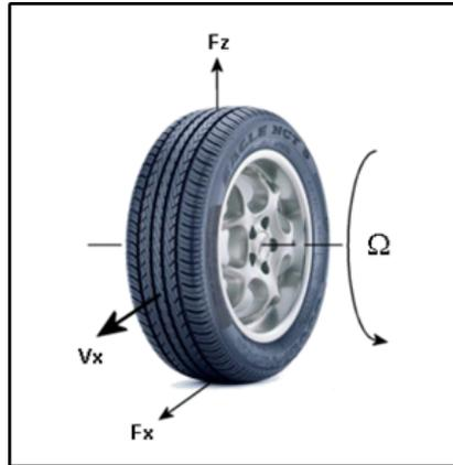
Figure 1.10 Efforts et vitesses angulaire et longitudinale sur une roue
