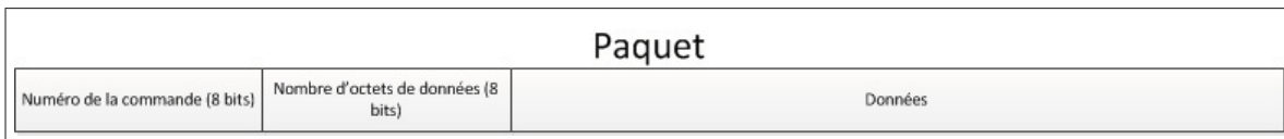
Figure 5.8 Définition du paquet utilisé dans le protocole de communication entre le DSP et l'interface utilisateur
