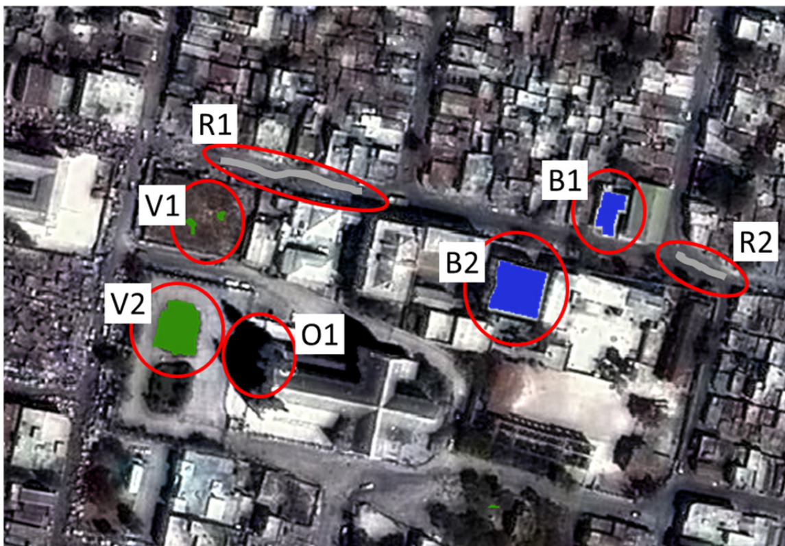
Figure 3.14 Objets sur lesquels la sensibilité des paramètres est évaluée avec R pour les routes, B pour les bâtiments, V pour la végétation et O pour les ombres
