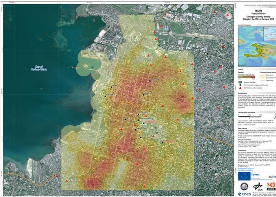
Figure 0.2 Haïti janvier 2010 - Dégâts par quartier préparée le 18 janvier 2010 Tiré du SERTIT (2010)
