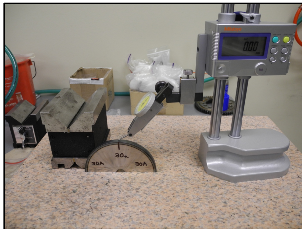
Figure 3.9 Montage utilisé pour la mesure de profondeur après polissage
