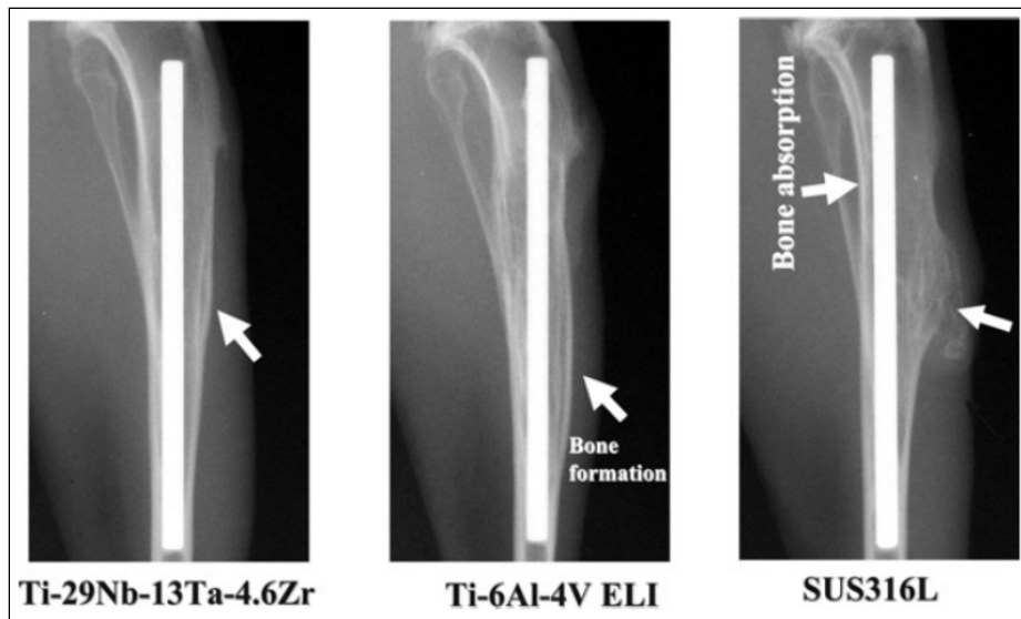
Figure 1.7 Radiographies des tibias de lapin après 24 semaines d'implantation des différents implants métalliques Tirée de Niinomi (2008)
