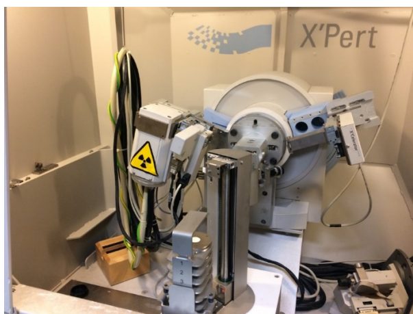
Figure 23. Diffractomètre de poudre PANalytical X'Pert Pro MPD
