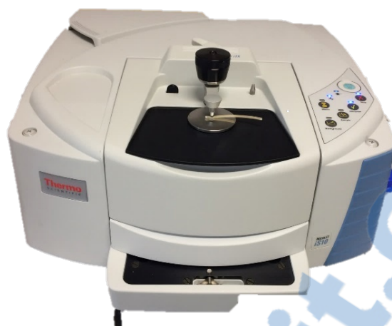
Figure 24. Spectromètre ATR-IRTF pendant une analyse d'échantillon
