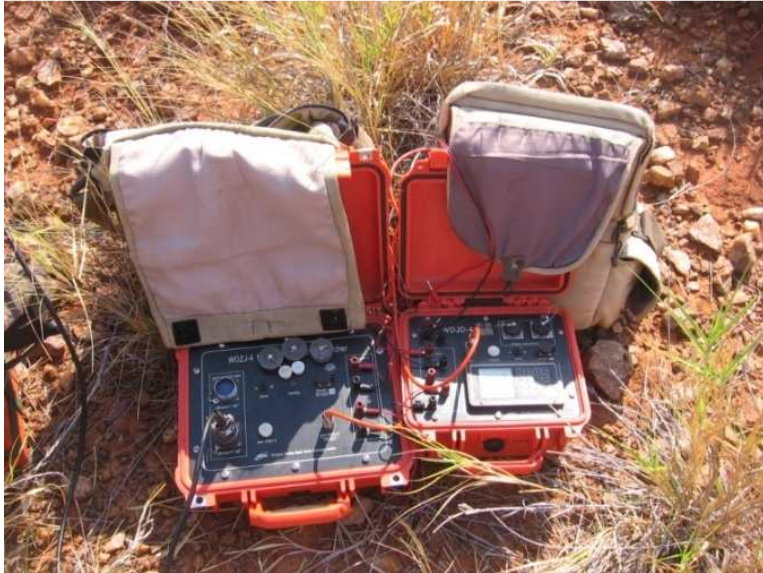
Photo 1 : Installation du résistivimètre WDJW-4
