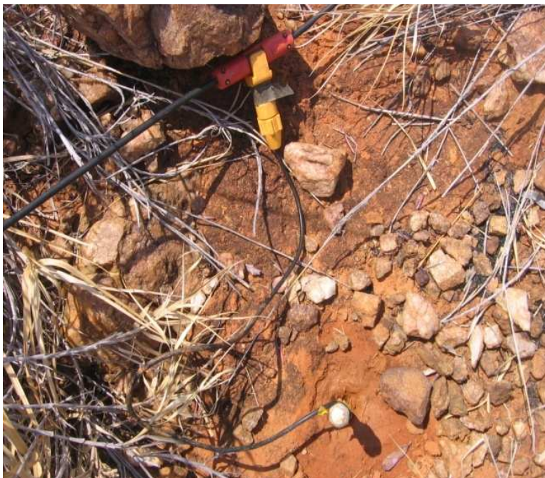
Photo 2 : Installation des électrodes
