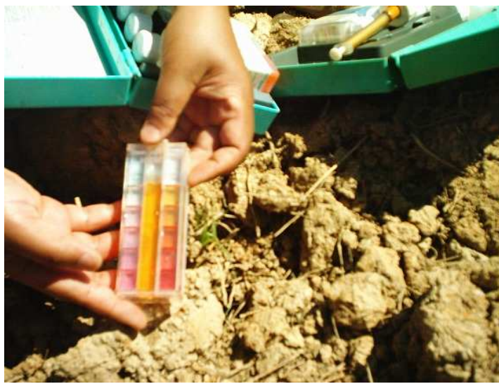
Photo N°8 : Mesure du pH de l'eau par la comparaison colorimétrique. (Auteur, 2003)
