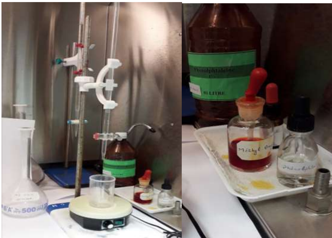
Figure IV. 7 : L'essai de titrage de l'alcalinité.
