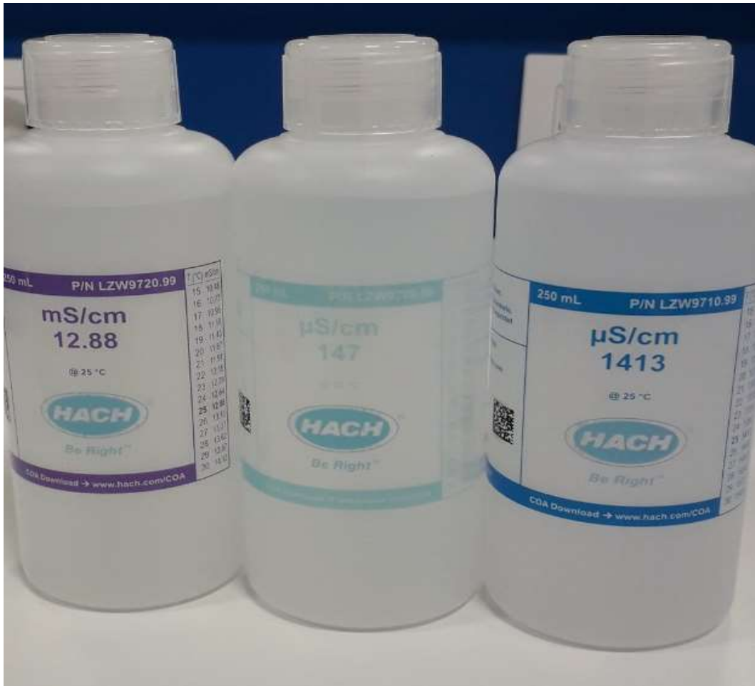
Figure IV. 6 : Les solutions tampons de conductivité.
