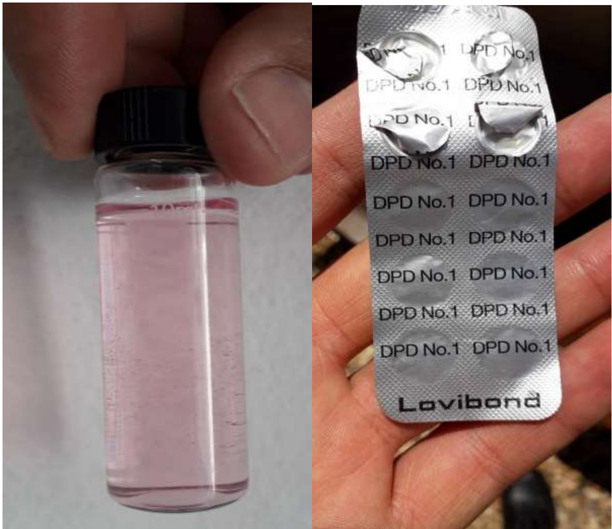
Figure IV. 10 : Mesure de chlore.
