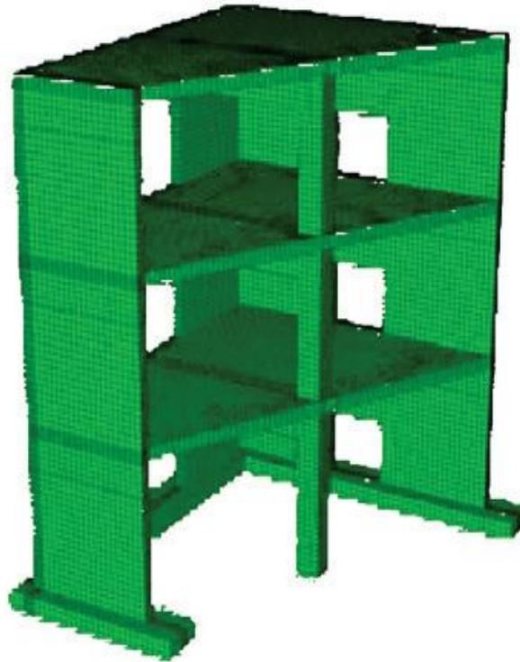
Figure 1.14- Discrétisation locale tridimensionnelle d'une structure – Projet Ecoleader -Structure Camus[34]
