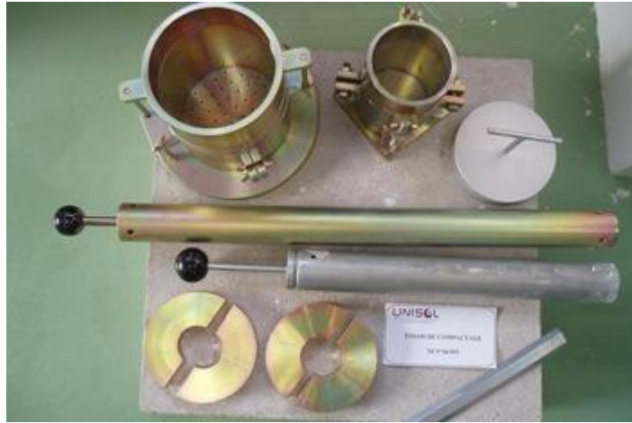
Photo II.3: le moule Proctor normal et CBR
