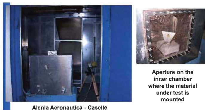
FIG. 4.3 – Méthode de la chambre réverbérante [3].
