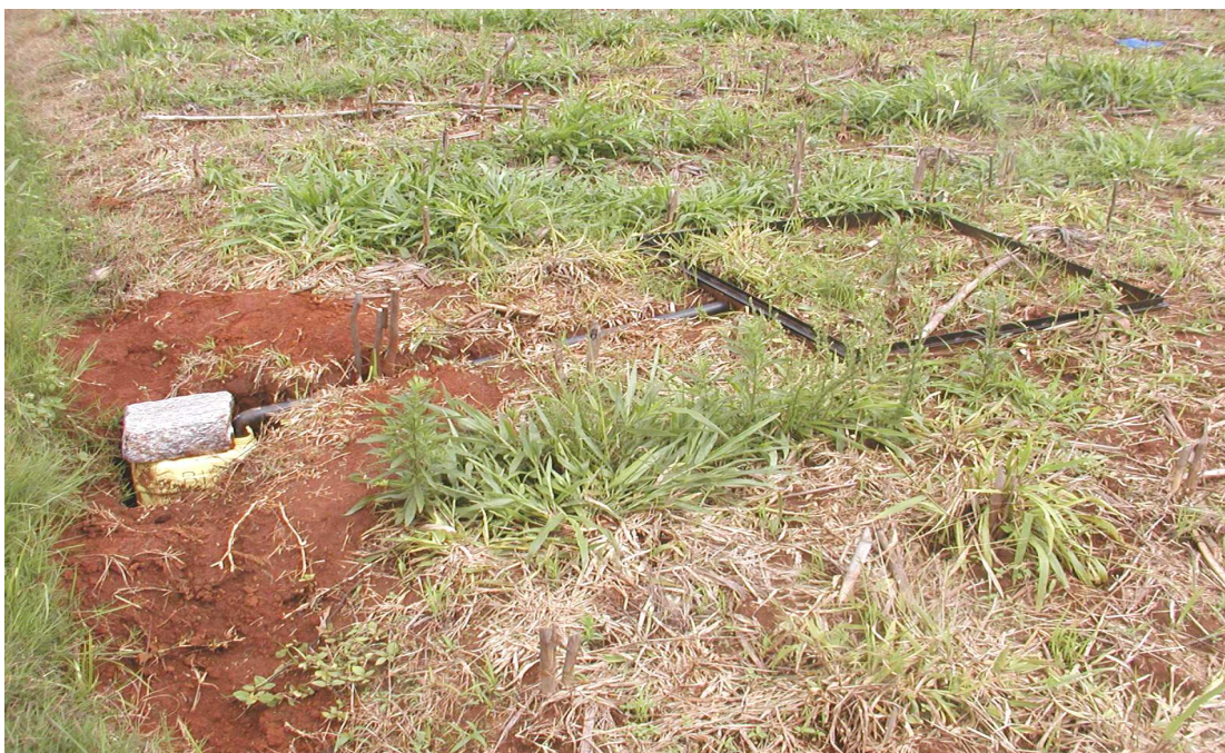
Cliché 2 : Micro-lot pour mesurer les ruissellements – érosions
