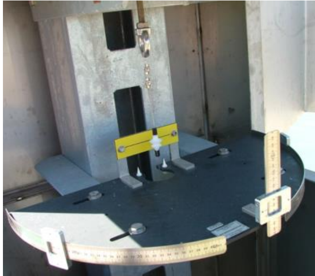
Photo III.3 : Appareil de mesure des déplacements relatifs. Pendule à table de visée avec mesure en Z
