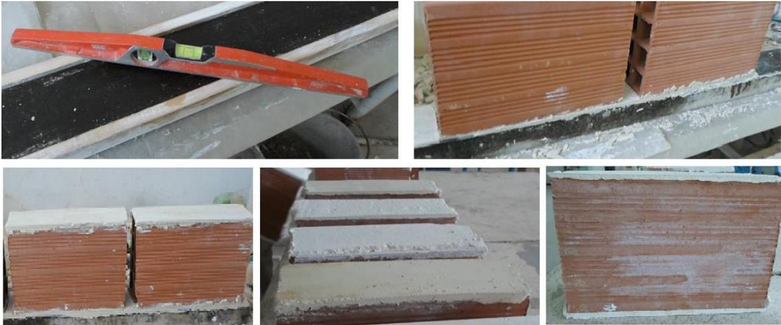
Figure 3.6 : Surfaçage des briques (Photos prises par les auteurs).
