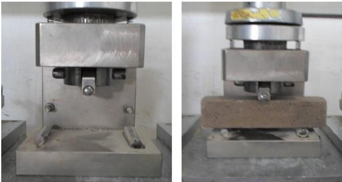
Figure 3.13: Dispositif de l'essai de flexion 3 points et les éprouvettes de mortier 4×4×16 (photos prises par les auteurs).
