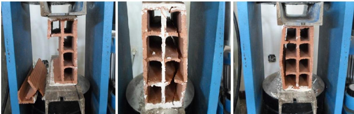
Figure 3.7 : Essai de compression des briques creuses (Photos prises par les auteurs).
