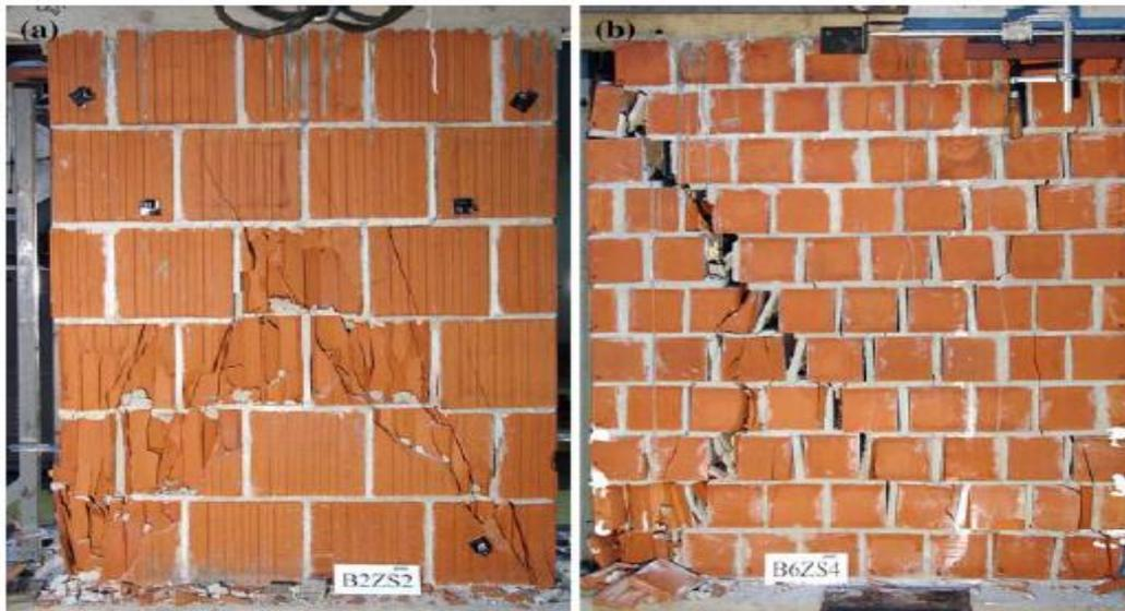
Figure 2.16: Les modes de rupture des murs : a) en briques creuses b) briques perforées [Tomazevic 2008].
