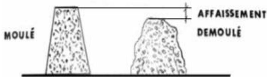
Figure 1.5 : essai d'affaissement au cône d'Abrams.
