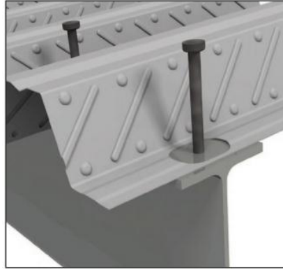
Figure IV.6. Goujons à tête soudée avec le profilé.
