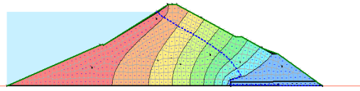
Figure 5.20 : Charge hydraulique pour un drain horizontal de 81 m et une anisotropie de 3
