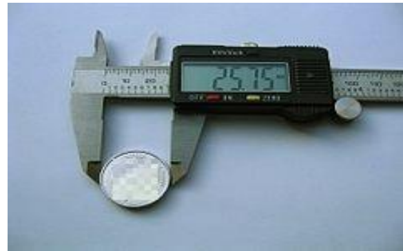
Figure 2.3: Mesure du diamètre et épaisseur
