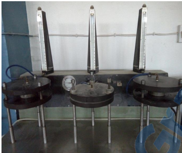
Figure III.12 : Essai de perméabilité à l'eau (Kamèche Z., 2015)
