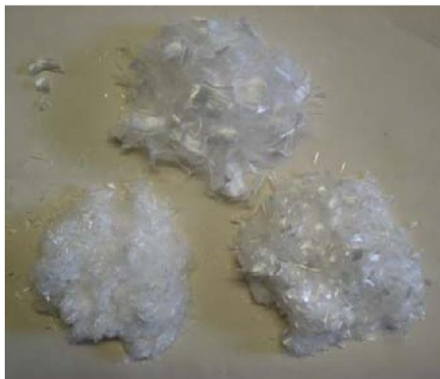
Figure I.6: la représentation de la FPP de 6 ; 12 ; 19mm.(Najimi et al., 2009)
