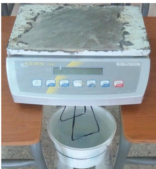
Pesage des échantillons immergé à l'eau et en air.
