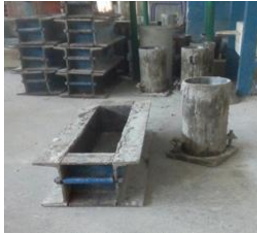
Figure III.3 : les moules utilisés pour notre programme expérimental (à gauche prismatique de 40x10x10 cm et à droite cylindrique de 11x22 cm)
