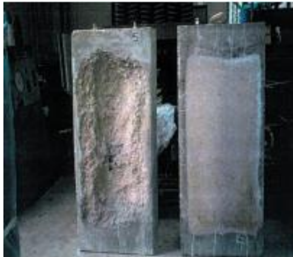
Figure I.16: Effet du feu sur les corps d'épreuve, sans fibres (à gauche, écaille), avec fibres polypropylènes (à droite, coloration) (Shuttle worth, 2001)
