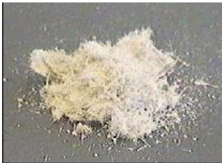
Figure I.2 : la représentation de la fibre d'amiante 3 .
