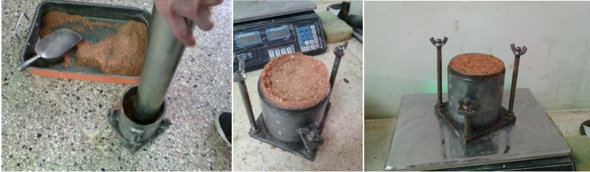
Figure 3.10 : Réalisation de l'essai de compactage.
