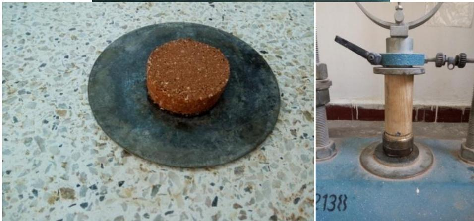
**Figure 3.13** : Préparation des échantillons par compactage statique.
