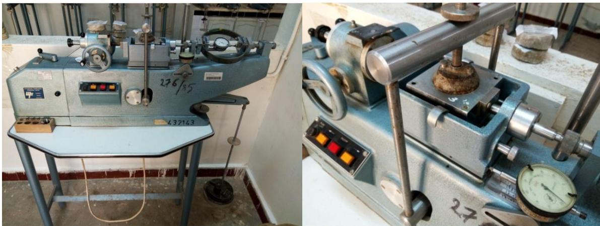
**Figure 3.17** : L'appareil de cisaillement.
