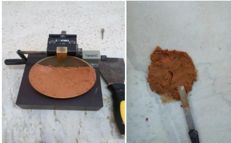
**Figure 3.6 :** Réalisation de l'essai de limite de liquidité.
