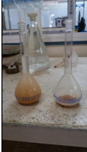
**Figure 3.9** : Réalisation d'essai de Pycnomètre.
