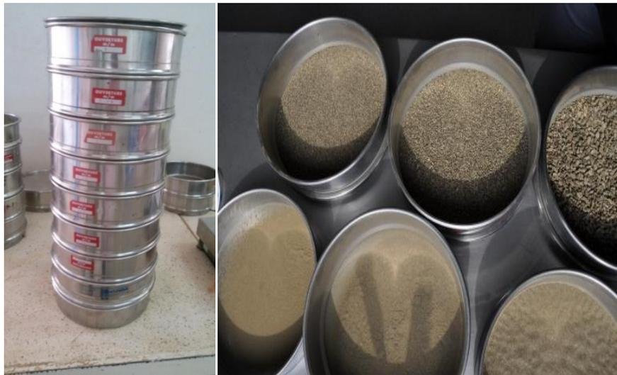
**Figure 3.2 :** Analyse granulométrique par tamisage.
