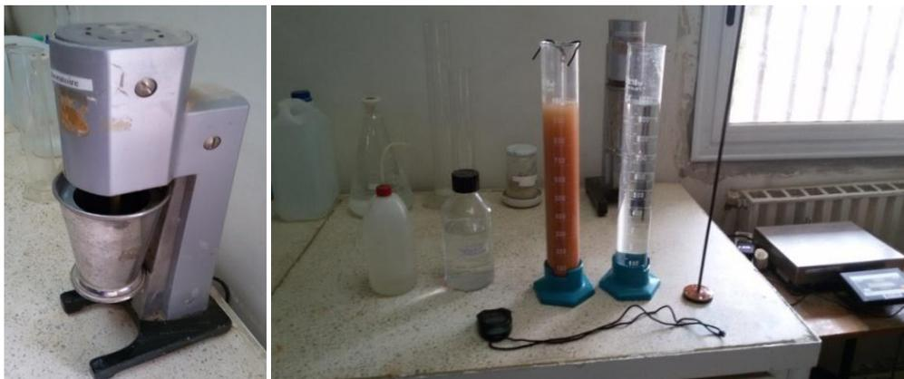
**Figure 3.3 :** Analyse granulométrique par sédimentation.
