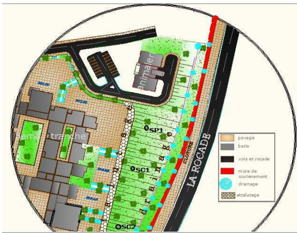
Figure IV.7 : Plan schématique d'implantation des sondages
