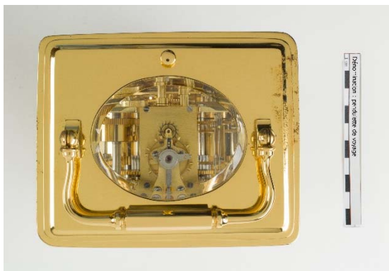
Figure 149 : pendulette de voyage, vue générale de la partie supérieure. Photographie standard en lumière blanche. On peut voir l'échappement à ancre.
