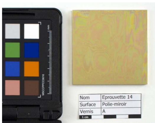
Figure 82 : éprouvette polie-miroir, 14, vernis A. Photographie standard en lumière blanche, angle lumineux 45°.
