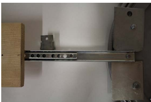
Figure 171 : détails coulisse à tiroir et plaques métalliques.
