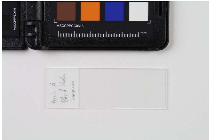
Figure 206 : vernis A appliqué sur une lame polie de verre par immersion chauffée.
