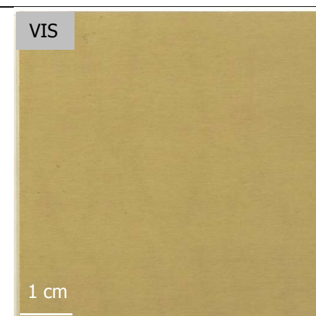
Figure 214 : éprouvette satinée 31 (verniss A). Photographie en lumière blanche, angle 45°.
