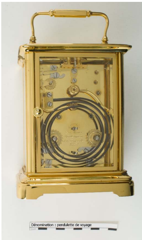
Figure 147 : pendulette de voyage, vue générale de l'arrière. Photographie standard en lumière blanche. Spirale du gong visible. Les mesures XRF ont été effectuées sur la partie basse du boîtier.
