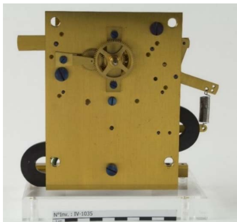
Figure 117 : vernis jaune sur une platine en alliages cuivreux. Photographie standard en lumière blanche.
