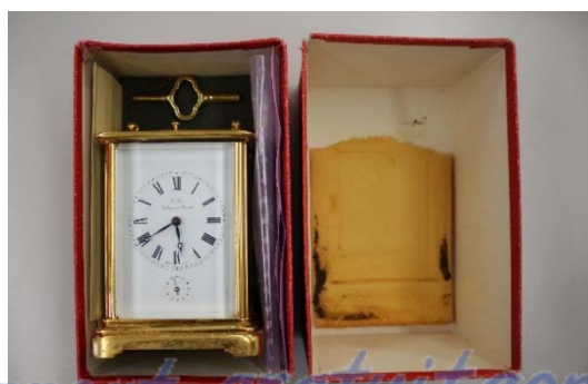
Figure 155 : pendulette dans sa boîte. La mousse polyuréthane est collée à l'intérieur du couvercle.
