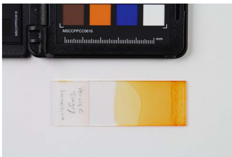
Figure 208 : vernis C appliqué sur une lame polie de verre par immersion.
