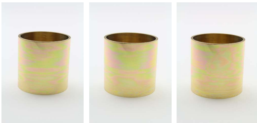
Figures 105, 106, 107 : éprouvette 7, polie-miroir, vernis A. Photographie standard en lumière blanche.
