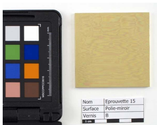
Figure 84 : éprouvette 15, polie-miroir, vernis B. Photographie standard en lumière blanche, angle lumineux 45°.
