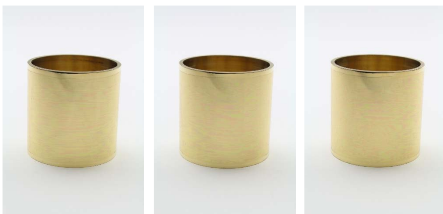
Figures 109, 110, 111 : éprouvette 8, polie-miroir, vernis B. Photographie standard en lumière blanche.
