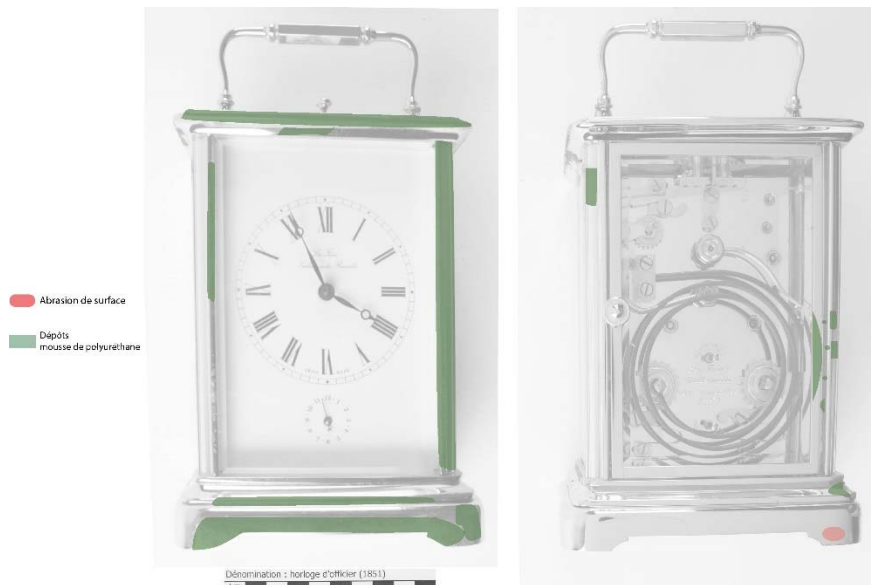
Figure 156 : constat d'état de la face et du revers de la pendulette de voyage.
