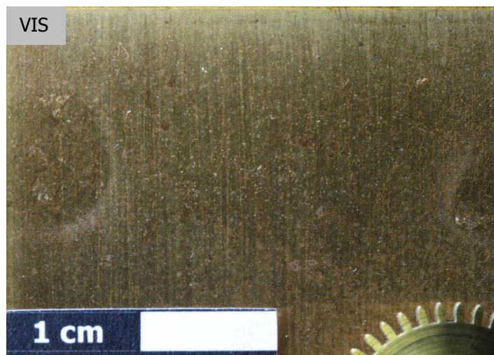
Figure 59 : Horloge à mouvement secondaire, platine orange, détail du chanci. Macrophotographie en lumière semi-rasante.
