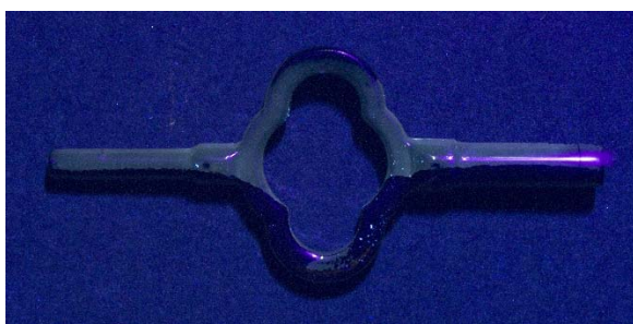
Figure 152 : clé de remontage de la pendulette de voyage, face A sous fluorescence UV. On distingue les zones du vernis intactes (autofluorescence teinte froide bleu-vert).
