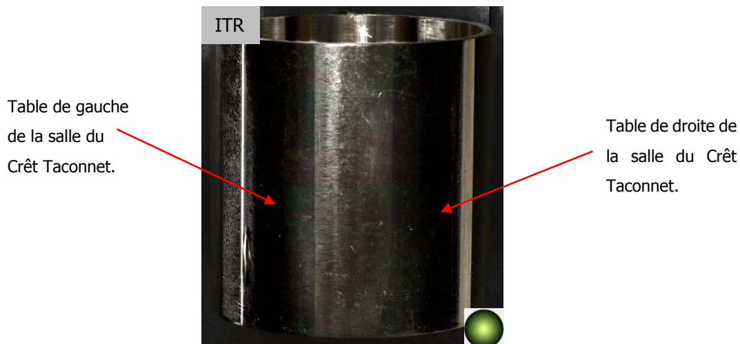
Figure 202 : essai sur l'éprouvette 7, forme cylindrique. Le fichier est parasité par les conditions de prises de vue (tables). La partie lisible n'est pas représentative de l'objet. Mode Specular Enhancement xy0, DC40_S70_HS75
