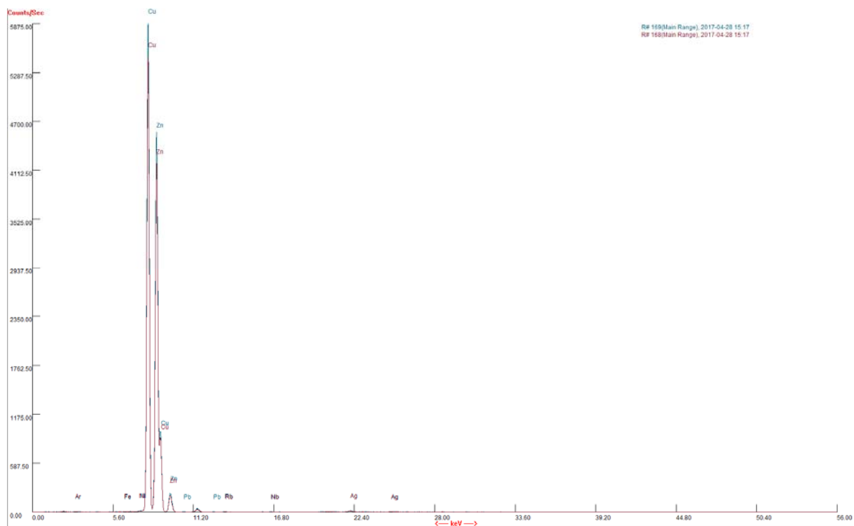
Spectre 6 : Spectre XRF pour la pendulette de voyage. Il n'y a pas d'or. Analyse effectuée à l'arrière, sur la partie basse du boîtier, en mode « Alloy coating ». © HE-Arc CR, Aline Michel
