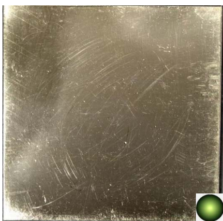
Figure 204 : éprouvette polie-miroir 15 (verniss B). Le voilage blanc est causé par le halo lumineux du flash. Capture d'écran fichier ITR, mode Specular Enhancement. DC0_S48_HS1_xy0
