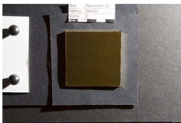
Figure 32 : exemple d'une prise de vue pour une séquence d'image ITR sur une éprouvette satinée.
