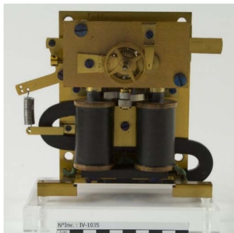
Figure 118 : vernis orange appliqué sur une platine en alliage cuivreux. Le système électroaimant, constitué notamment des bobines, est situé en dessous. Photographie standard en lumière blanche.
