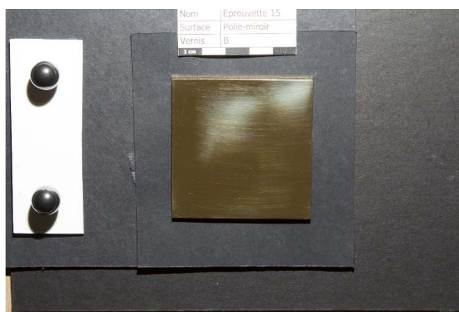
Figure 205 : phénomène du halo lumineux sur une des prises de vue de la même éprouvette.
