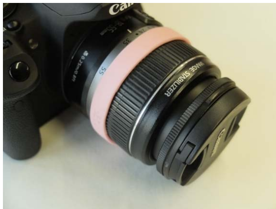
Figure 180 : bracelet élastique autour de l'objectif pour éviter tout mouvement.
