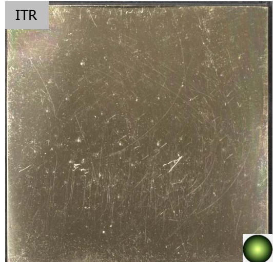
Figure 234 : éprouvette polie-miroir 14 (verniss A). Capture d'écran fichier ITR, mode Specular Enhancement. DC100_S50_HS44_xy0
