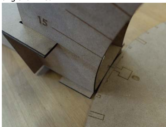
Figure 193 : alignement du bras rotatif sur le plateau stationnaire
