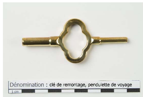
Figure 28 : vue générale de la clé de remontage de la pendulette de voyage.
