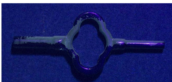
Figure 154 : clé de remontage de la pendulette de voyage, face B sous fluorescence UV. On distingue les zones du vernis intactes (autofluorescence teinte froide bleu-vert).
