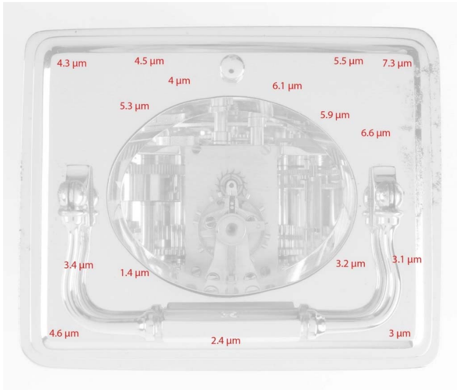
Figure 162 : pendulette de voyage, mesures d'épaisseur par courant Foucault
