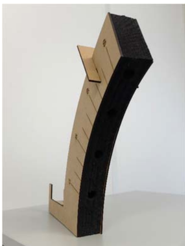
Figure 177 : fixation du flash dans la mousse de polyéthylène haute densité.
