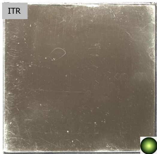
Figure 240 : éprouvette polie-miroir 5 (référence sans vernish). Capture d'écran fichier ITR, mode Specular Enhancement. DC100_S50_HS1_xy0
