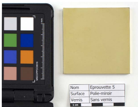
Figure 88 : éprouvette 5, polie-miroir, sans vernis. Photographie standard en lumière blanche, angle lumineux 45°.
