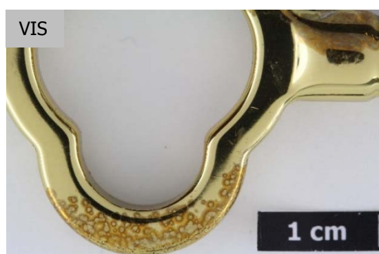
Figure 65 : Détail anneau de la clé de remontage. Macrophotographie en lumière blanche, angle lumineux 45°.
