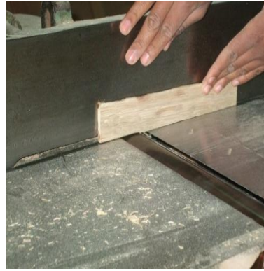
Photo 16: Passage des sections à la dégauchisseuse
