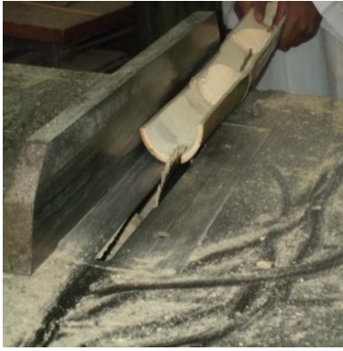
Photo 15: Passage des sections à la scie circulaire
