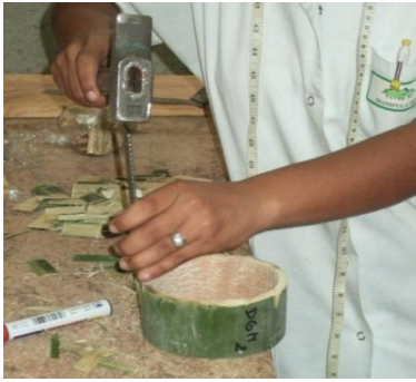
Photo 10: Ecorçage d'un anneau de bambou
