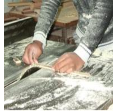
Photo 17: Façonnage des échantillons à l'aide d'une scie circulaire
