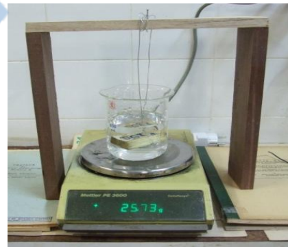
Photo 14: Mesure du volume de l'éprouvette (méthode d'Archimède)
