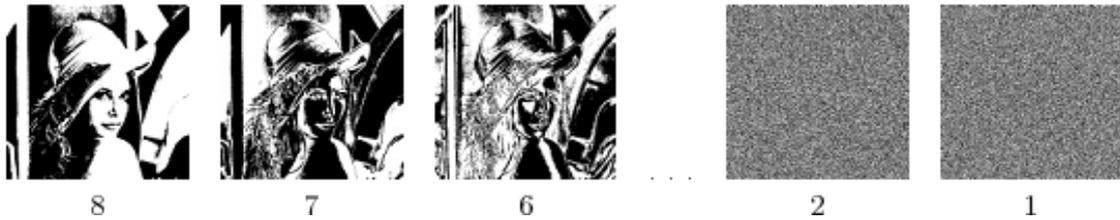
**Figure 2.06:** *Décomposition en plan binaires des bits de poids forts jusqu'aux bits de poids faibles*
