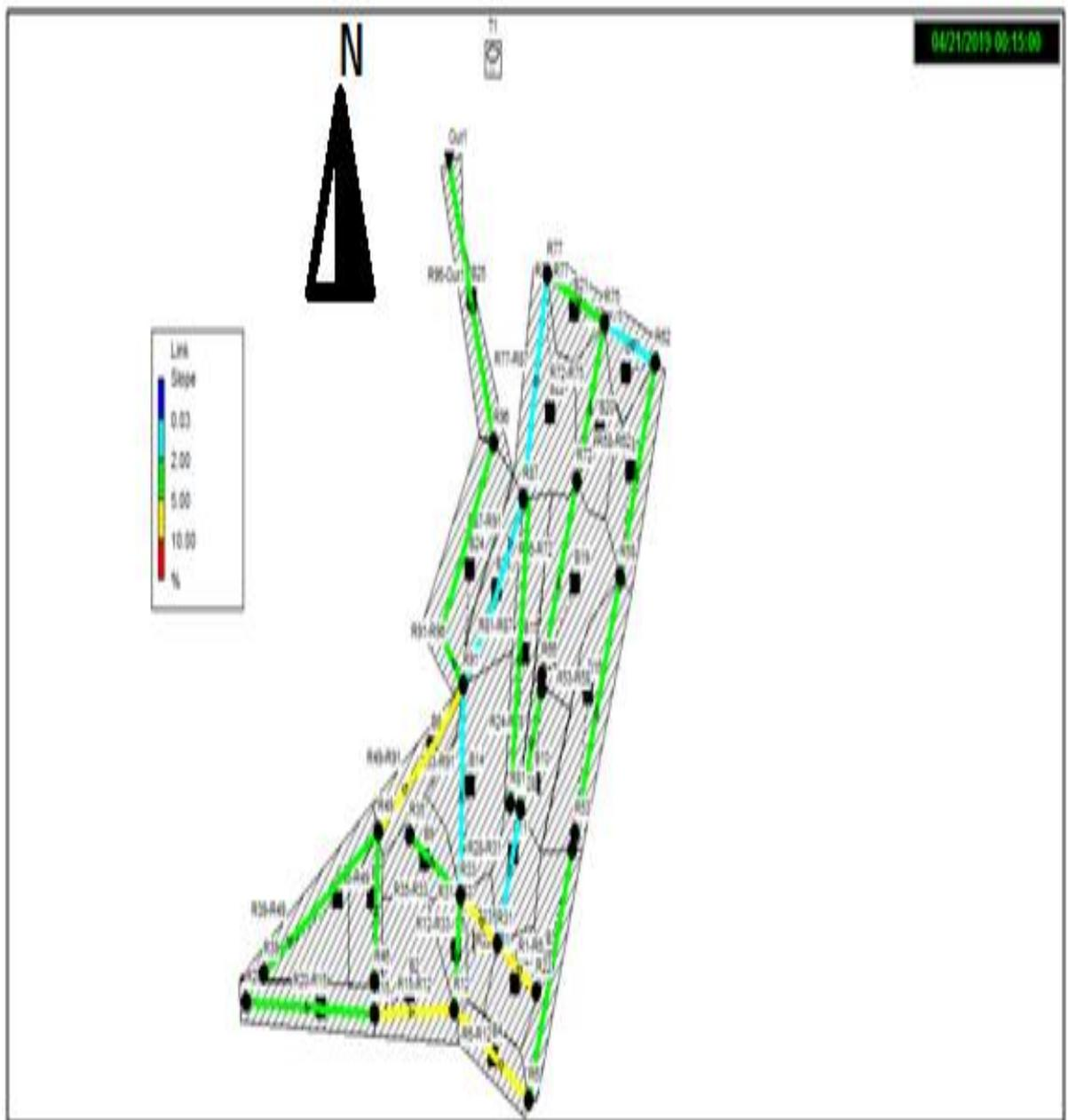
**Figure IV.15** : Pentes supérieures à 5% ; (Steady flow)
