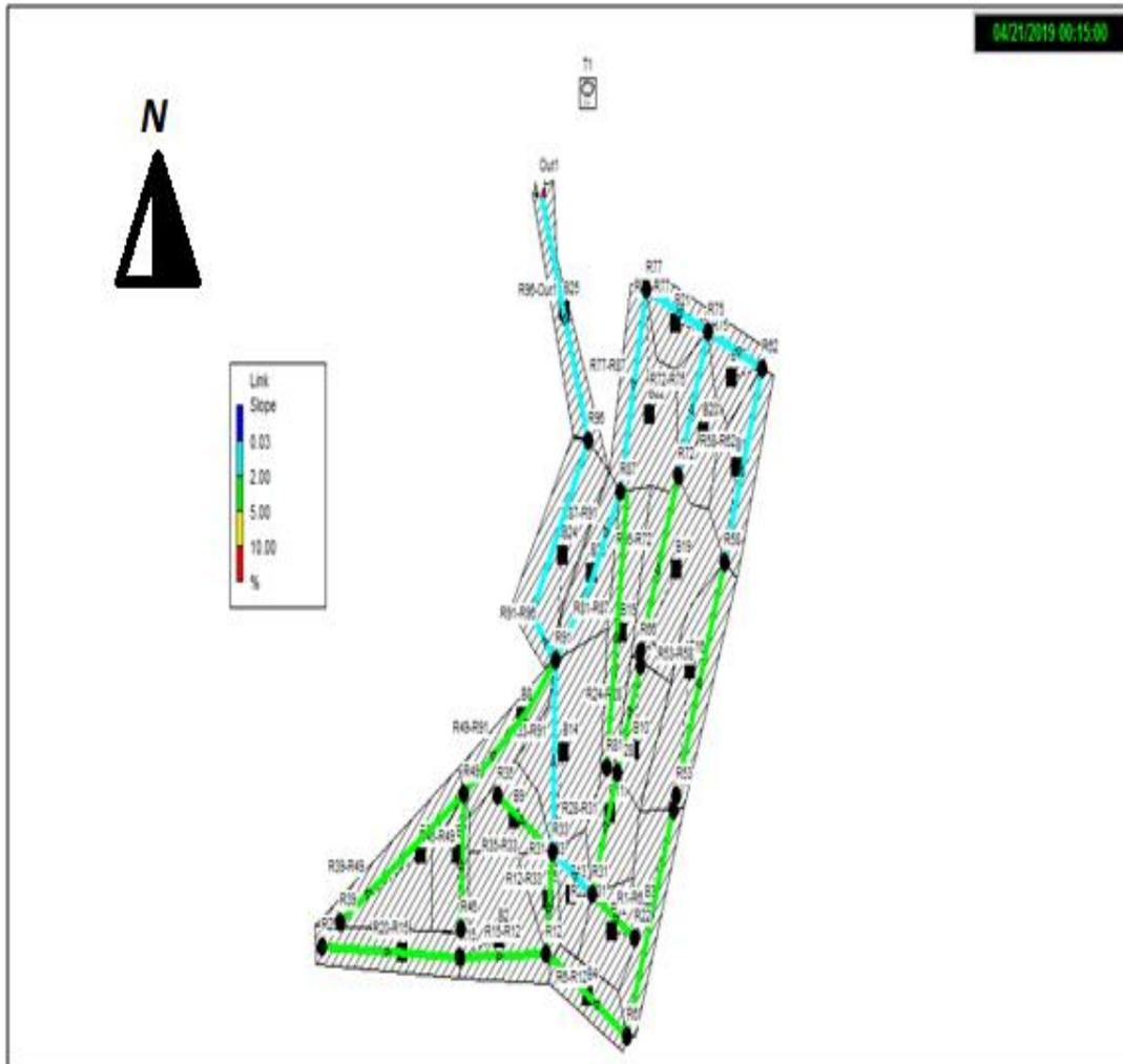
**Figure IV.23 :** Résultat des pentes de la simulation finale
