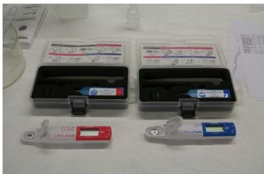
**Fig.225** pH-mètre Horiba Laquatwin® (en bleu, à droite) utilisé pour effectuer les mesures de pH et vue du dispositif sur la membrane de la parka 4
