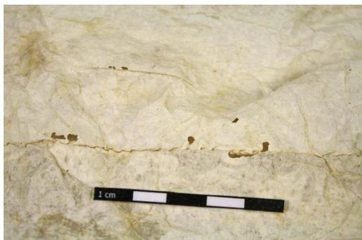
**Fig.55** Trous d'insectes induisant des lacunes des membranes (parka 4)
