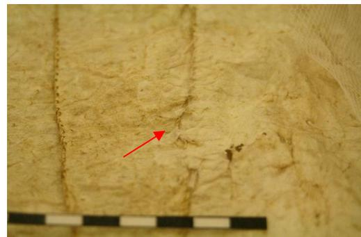
**Fig.140** Vue d'une couture rompue, située au dos de la parka, après consolidation
