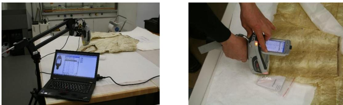
**Fig.218** Dispositif d'analyse FRX portable avec bras articulé (à gauche) et utilisation de l'analyseur FRX in-situ (à droite)
