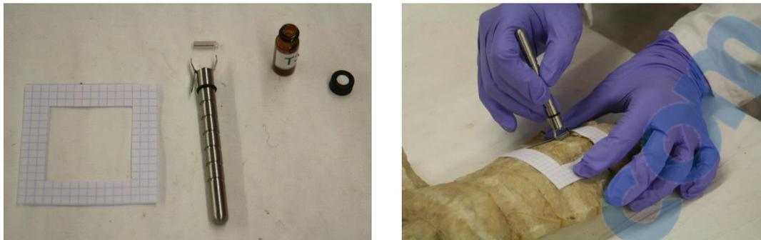
**Fig.221** Vue du matériel de prélèvement et de l'utilisation de l'extracteur lors du prélèvement
