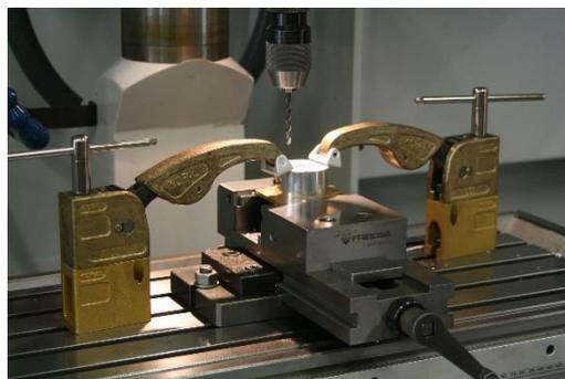
**Fig.157** *Réalisation des trous taraudés à la fraiseuse sur commande numérique*
