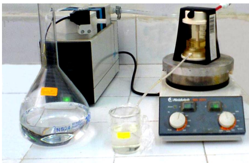
Photo. Dispositif de l'ultrafiltration avec la cellule Millipore Amicon™.
