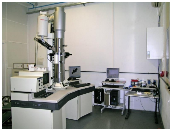
Figure 10 : microscopie électronique MET Hitachi 8100
