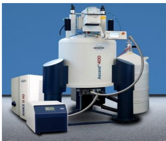
Figure 11 : Résonance Magnétique Nucléaire (RMN) 400 MHz
