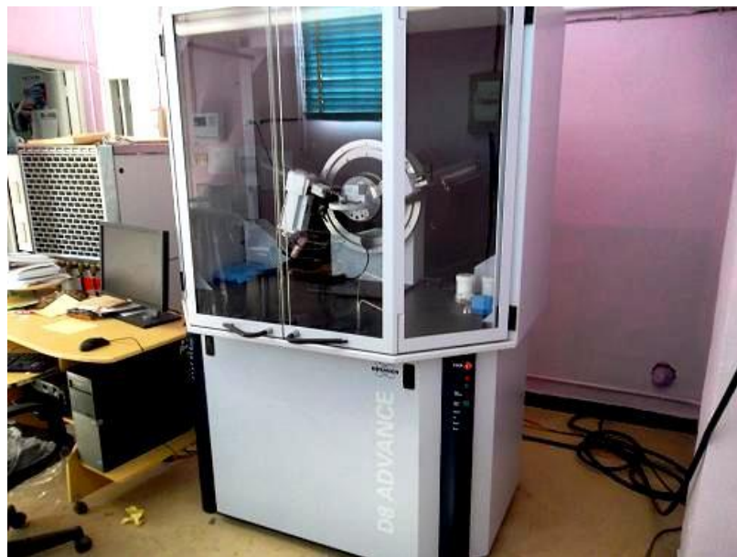
Figure 7 : Diffractomètre de rayons X, Bruker AXS D8 Advance Laboratoire de Chimie des Polymères Université Oran 1 A.B.
