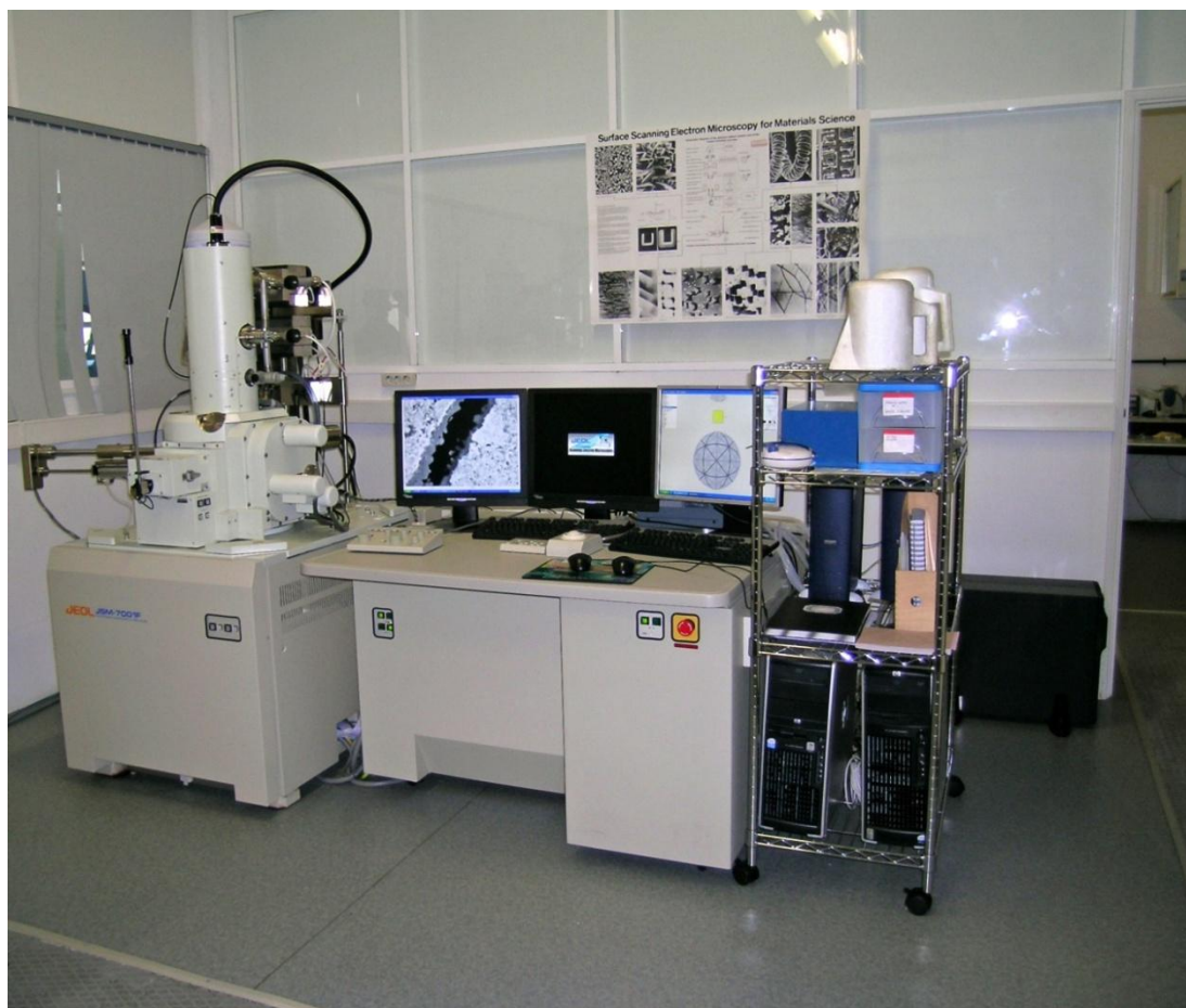
Figure 9 : Microscope Électronique à Balayage (MEB) « JEOL 7001F, FEG-SEM ».
