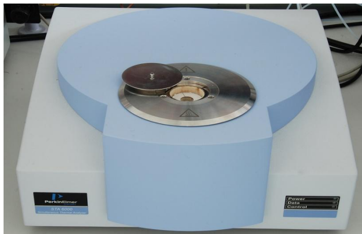
Figure 12 : Dispositif d'analyse thermogravimétrique (ATG) PerkinElmer STA 6000 Institut polytechnique de Leiria CDRSP, Portugal.
