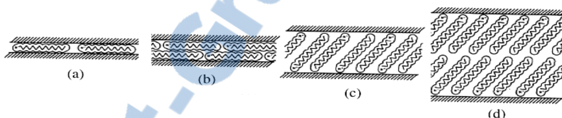
Figure 7 : Arrangement des ions alkylammonium entre les couches silicates du mica. (a) : monocouche, (b) : bicouche, (c) : pseudotrimoléculaire et (d) : paraffine [11].
