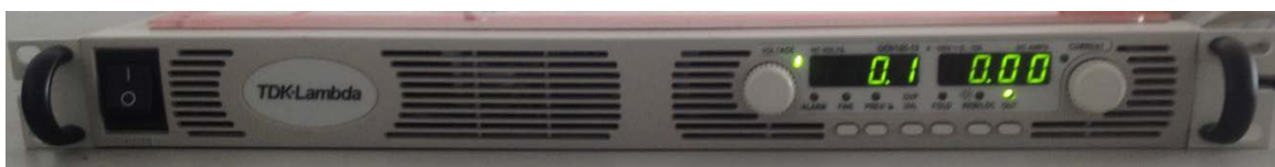
Figure 28: Alimentation externe stabilisée 100V-15A
