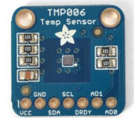
Figure 23 : TMP006 avec sa carte d'adaptation.
