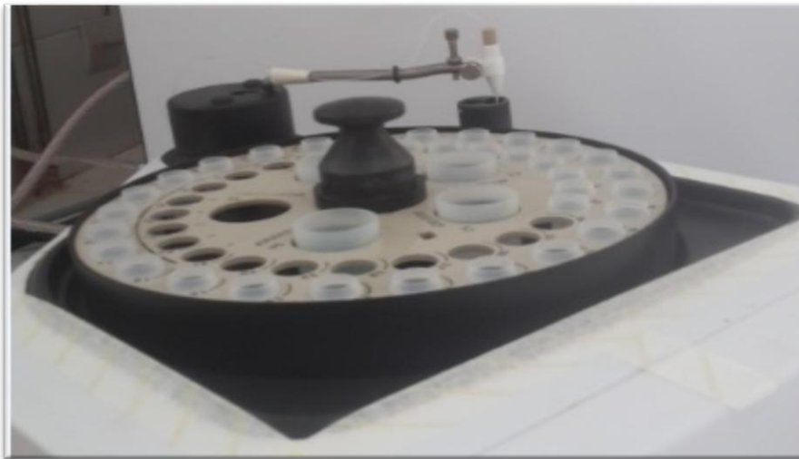
Figure 10 : Dispositif d'injection automatique
