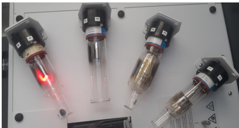
Figure 16 : Lampe (allumée) à cathode creuse correspond à l'Aluminium
