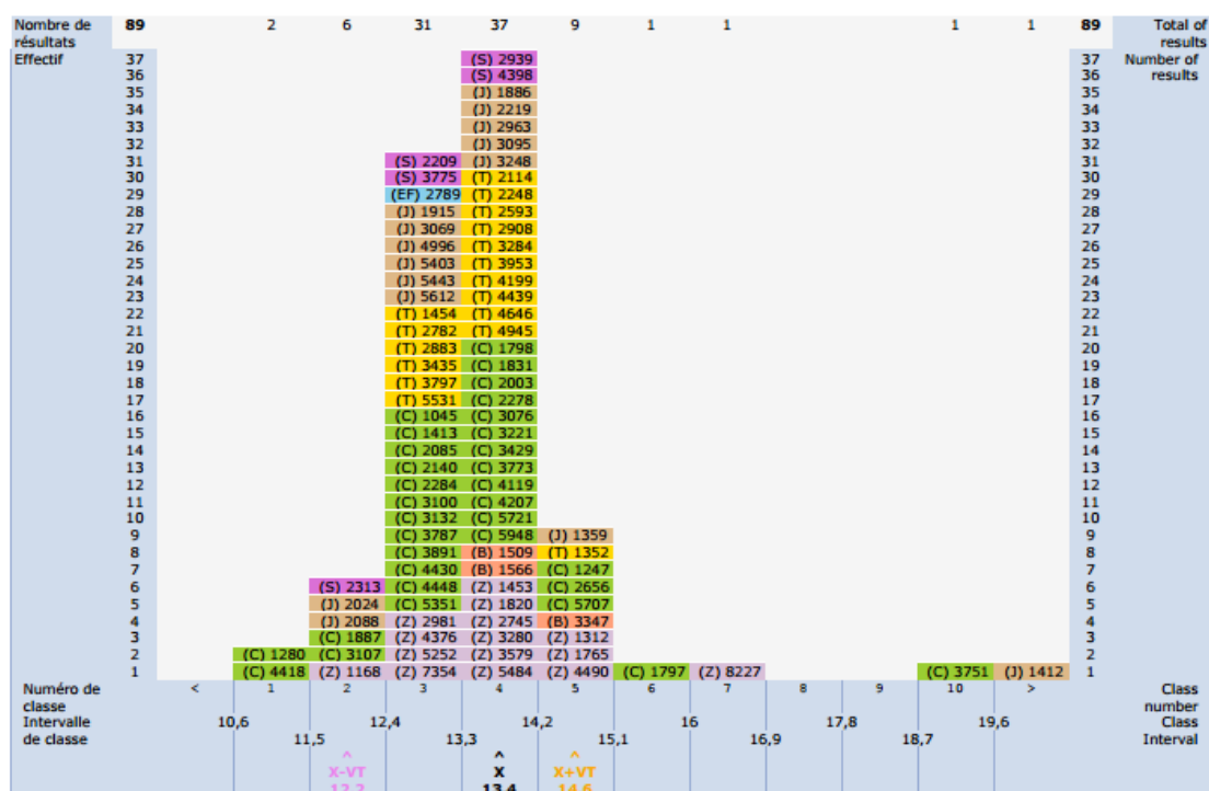
Figure 16 : essai de comparaison inter laboratoire pour le sodium
