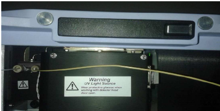
Figure5: Détecteur UV HPLC
