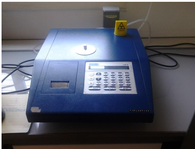
Photo 3 : Spectromètre de fluorescence XRF de type Oxford Lab-X 3000
