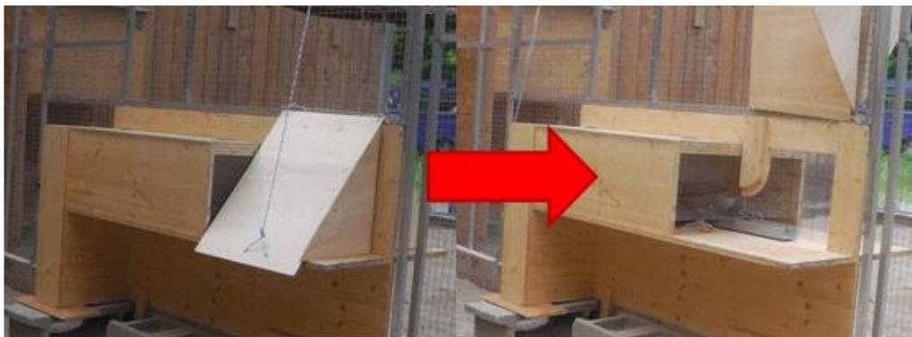
Enfin, nous avons réajusté la hauteur de la grille coulissante qui divise le compartiment expérimental en deux sections égales pour que l'appareil s'insère exactement dans l'espace spécifique créé et soit situé exactement au milieu du compartiment (voir figure 10).
