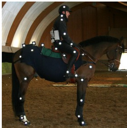
Figure 1 : Photographie d'un cheval équipé de marqueurs réfléchissants en regard des articulations des membres
