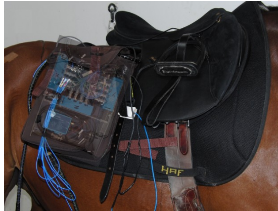
Figure 4 : Photographie du système d'acquisition placé dans une sacoche fixée sur le tapis de selle (les éléments électroniques sont schématisés par transparence)
