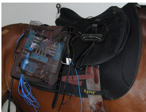
Figure 15 : Photographie du système d'acquisition placé dans une sacoche fixée sur le tapis de selle (les éléments électroniques sont schématisés par transparence).
