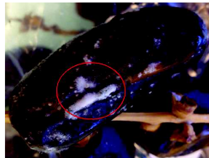
Altération par les moisissures
