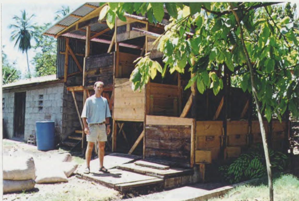
Photo 31 : Caisses de fermentation disposées en cascade
