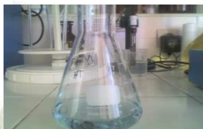
Dosage par la solution d'EDTA à 0,02 mol/l Jusqu'à l'obtention de la coloration bleue
