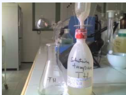
50 ml de l'échantillon à analyser + 5 ml d'une solution tampon
