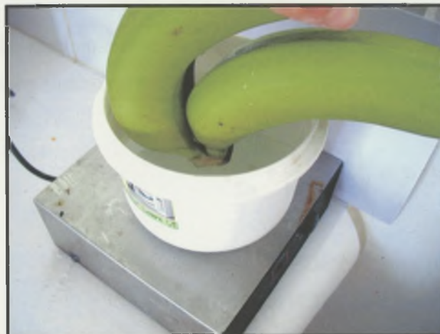
Figure 28 : Application des levures sur la couronne par trempage de dix secondes dans la solution de levures en agitation permanente.
