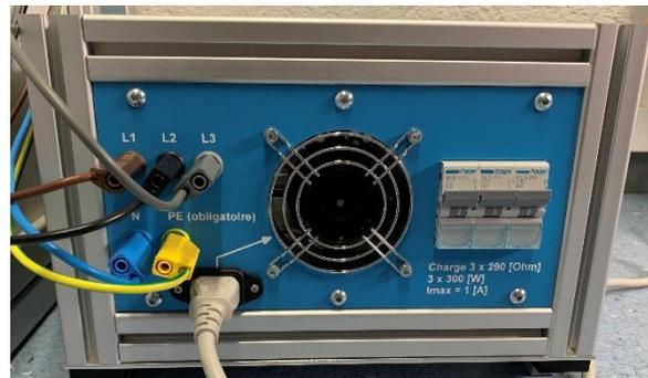
Figure 96: Rack de 290 ohms raccordés en étoile
