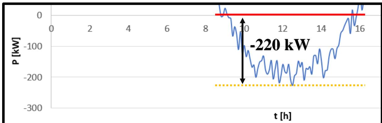
Figure 62: Illustration de la puissance de décharge nécessaire
