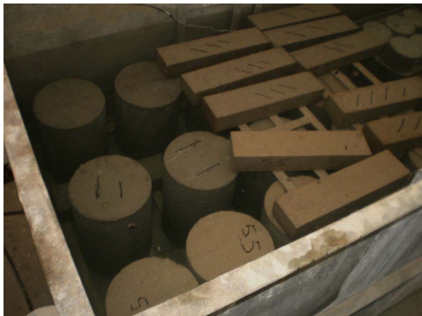
Figure 2. 4 Cure des éprouvettes (immersion totale dans l'eau).
