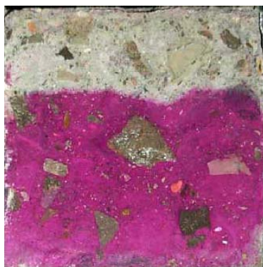
Figure 2. 11 Mise en évidence de l'épaisseur carbonatée par la solution de phénolphthaléine
