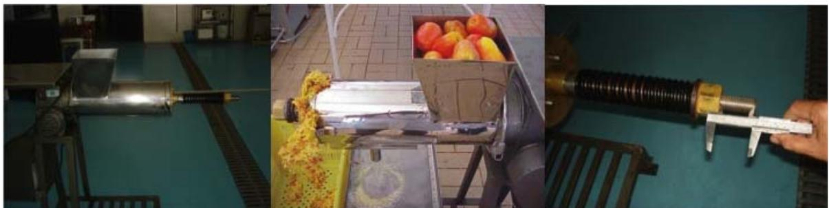
**Figure 10 :** Démonstration du réglage de la force appliquée sur la masse des fibres dans la presse INCOMAP – 300.
