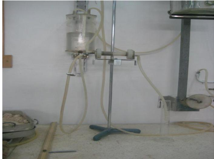
Photo 3.23 l'appareil de Pinhole test
