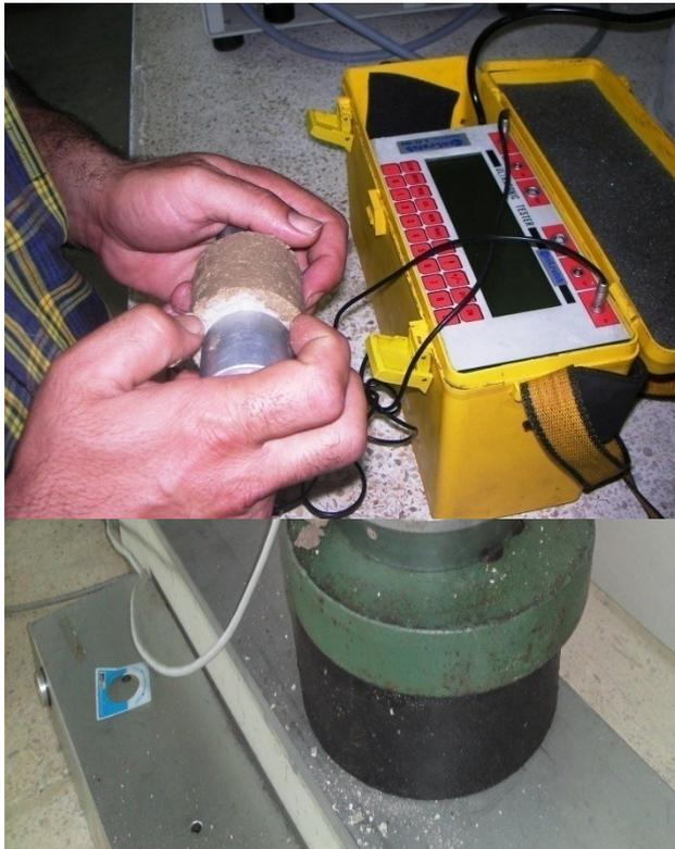
de compression diamétrale (l'essai brésilien)
