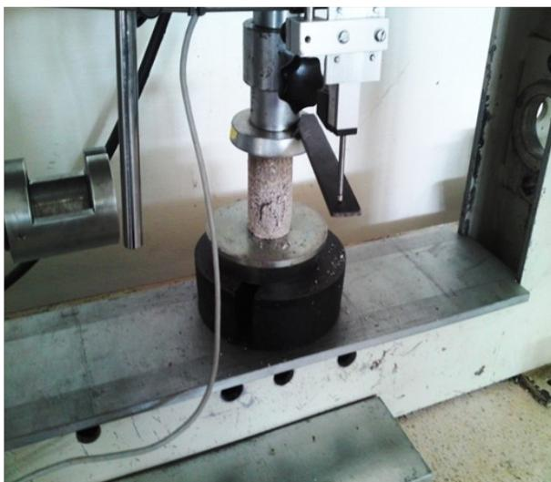
**Photo. (5.13) :** Mesure de la résistance à la compression simple des formulations étudiées par La presse avec un capteur
