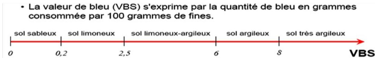
Figure (5.8): Nomination d'un sol en fonction de sa valeur au bleu de méthylène (VBS)
