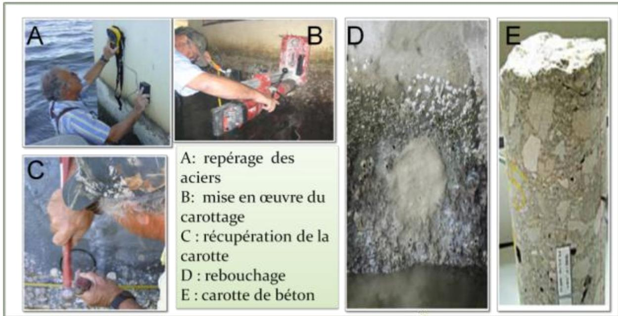
**Figure II.29** : Différentes étapes d'élaboration d'un carottage [VIRA, 07].
