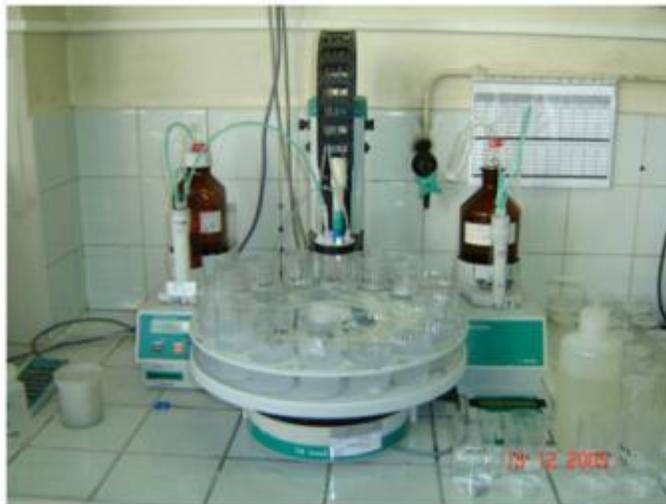
**Figure II.19** *Titrimètre pour le dosage des chlorures [MAH, 06]*
